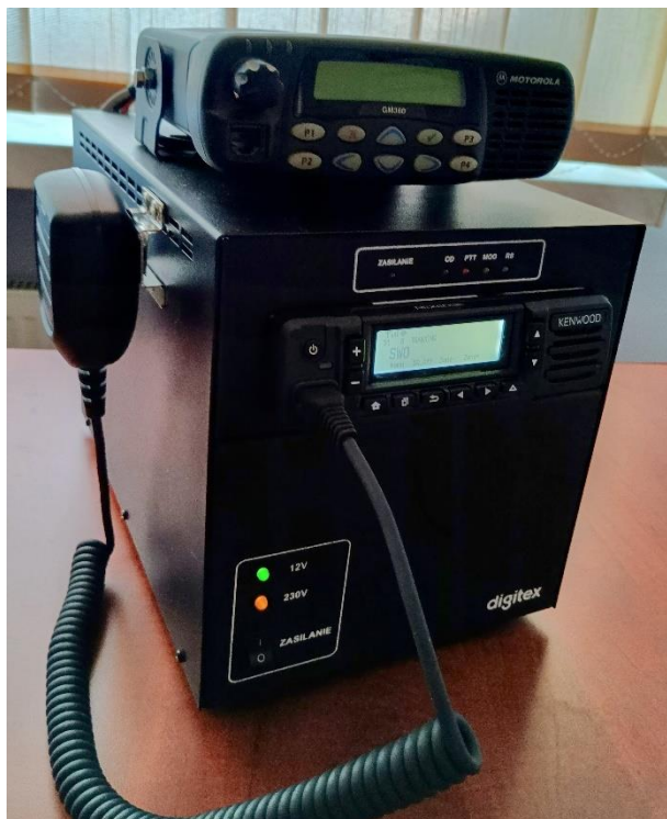
ZDJĘCIE 5 BAZOWA STACJA RADIOTELEFONICZNA
